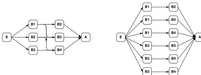
$$S=B1B2 \text{ or } B1B3 \text{ or } B1B4 \text{ or } B2B3 \text{ or } B2B4 \text{ or } B3B4$$
